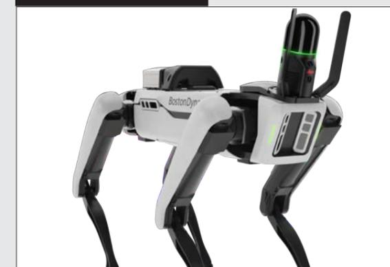
Mit der BLK ARC UI können Scanpfade aus der Ferne geplant werden, indem vorhandene Zeichnungen oder BIM-Modelle eines Gebäudes verwendet werden. Dies ermöglicht es, komplexe oder gefährliche Umgebungen zu scannen, während er sich an einem sicheren Ort befindet.
